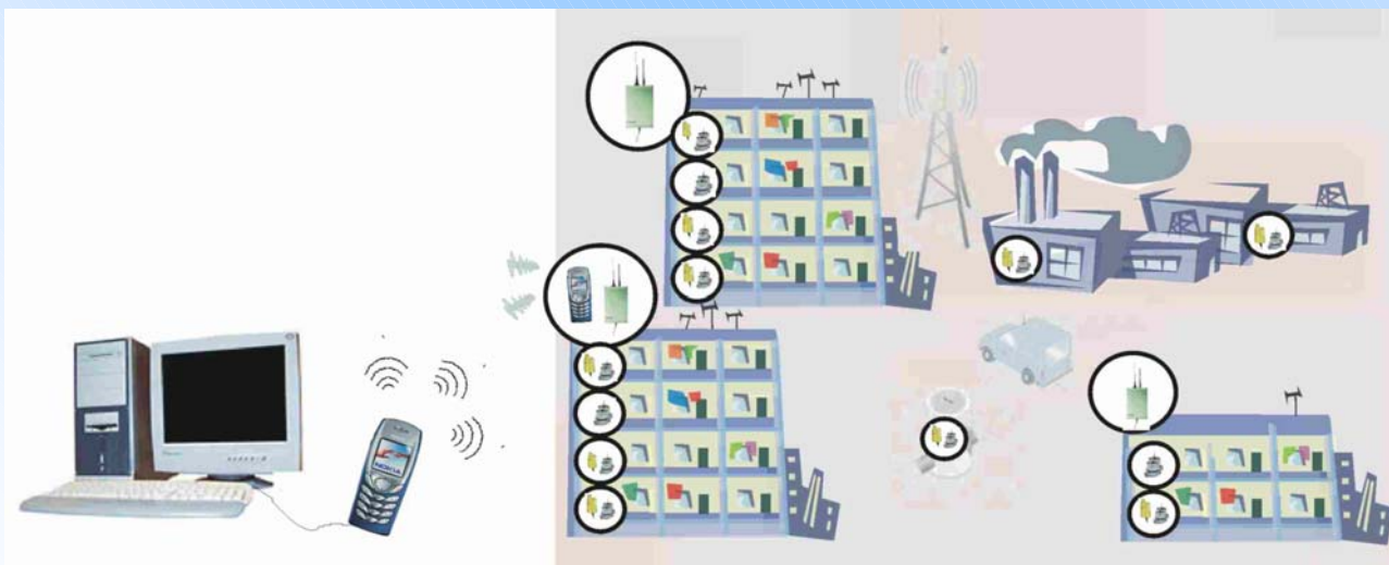
Schemat możliwości bezprzewodowego odczytu wodomierzy przy wykorzystaniu koncentratora.
